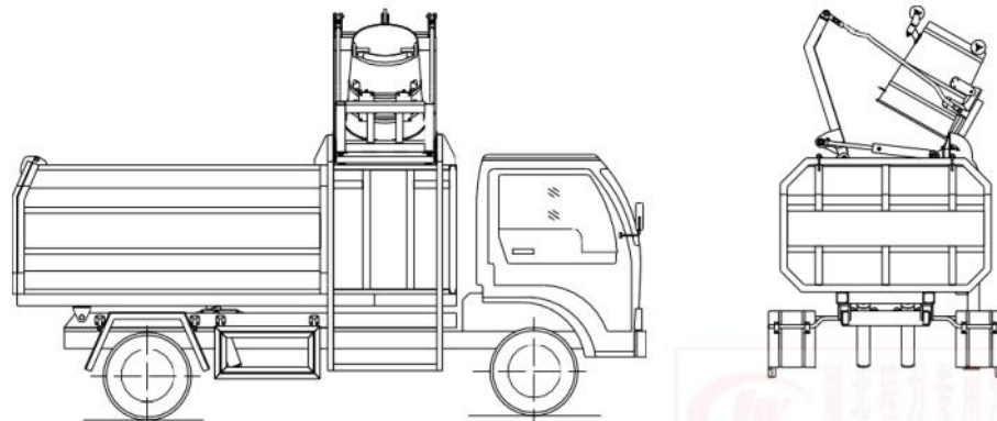
提升机提起垃圾桶收集垃圾简图
